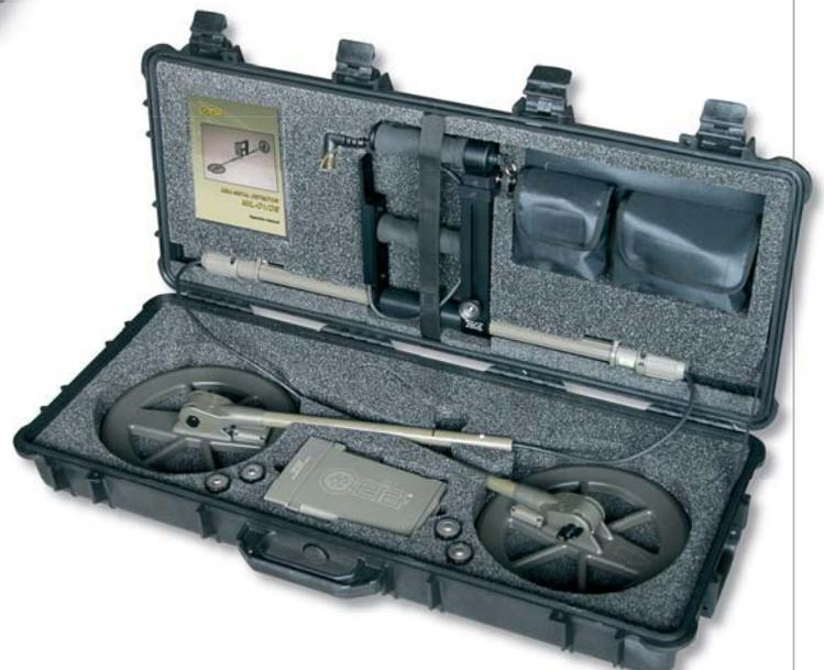
CEIAのMIL-D1/DS金属探知器は低周波の交差磁場伝送に基づくアクティブなEMIデバイスであり、地中深くに埋もれてる比較的大きな金属を探知する為に開発されました。
